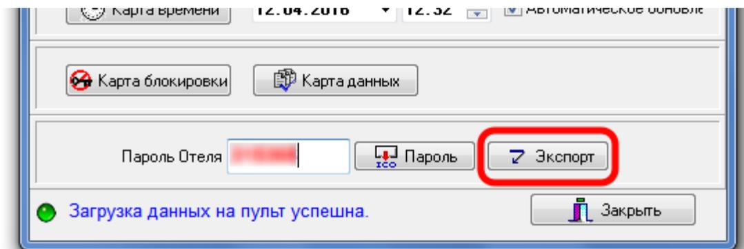
Поднесите устройство к энкодеру и нажмите кнопку «Экспорт» в программе. Далее нажмите кнопку «ОК» на устройстве. Для отмены изменения номера отеля – нажмите кнопку «Отмена» на устройстве.
